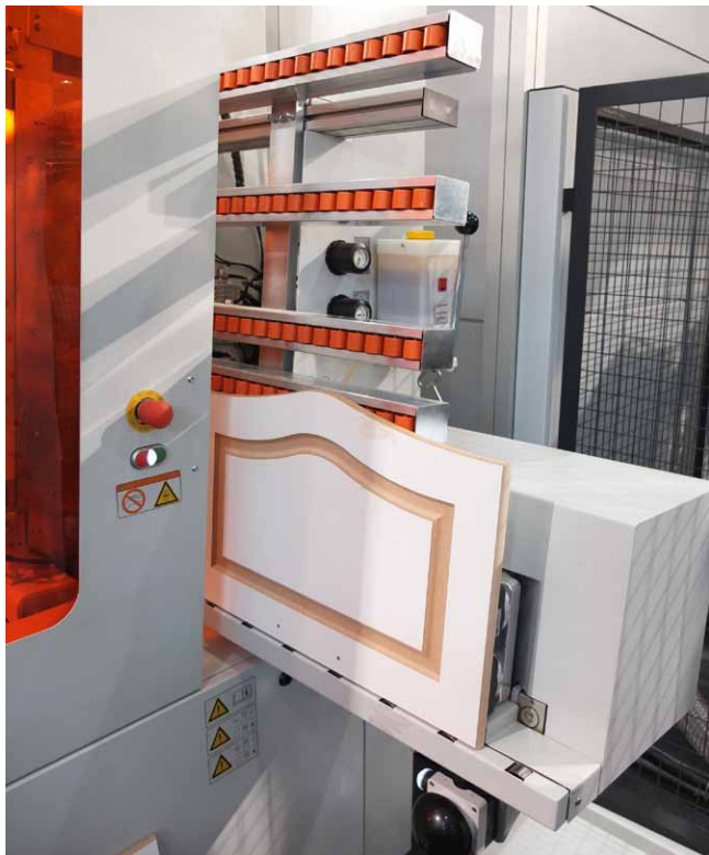
Upnutý dílec lze obrábět v ploše a po celém jeho obvodu
